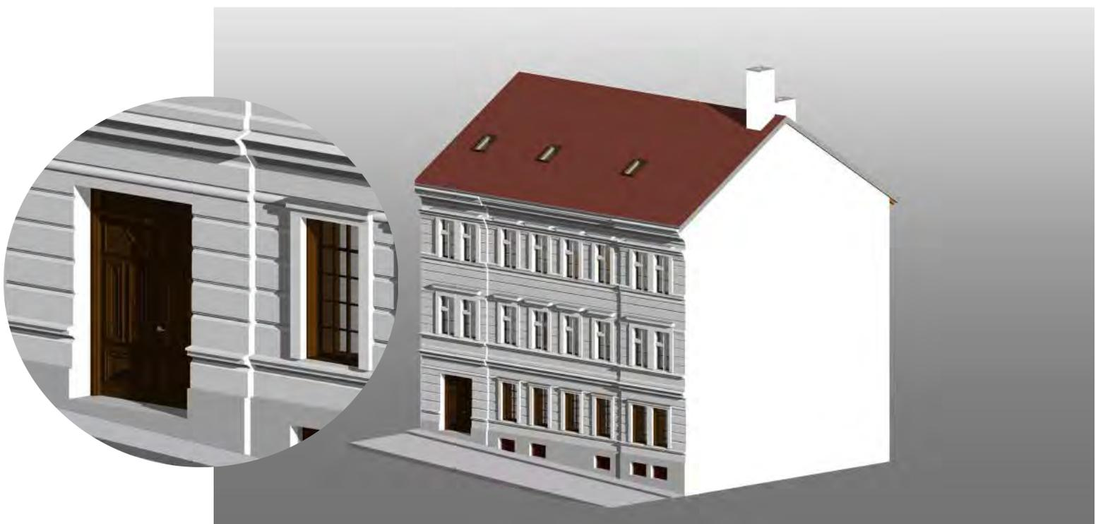
Eine Ergänzung von Informationen gemäß Projektdokumentation (PD) ist für Elemente möglich, die im Level of Detail 2–4 (L2–L4) modelliert werden.
